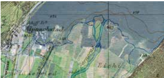
Überlagerung Luftbild 2021 mit den heutigen Baggerbuchten und Landeskarte 1926 mit damaliger Seeuferlinie und Verlauf der Sarnera in blauer Farbe
