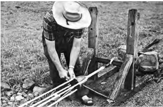
Hier entsteht von Handarbeit ein Seil durch das Zusammen-drehen von 4 Litzen
