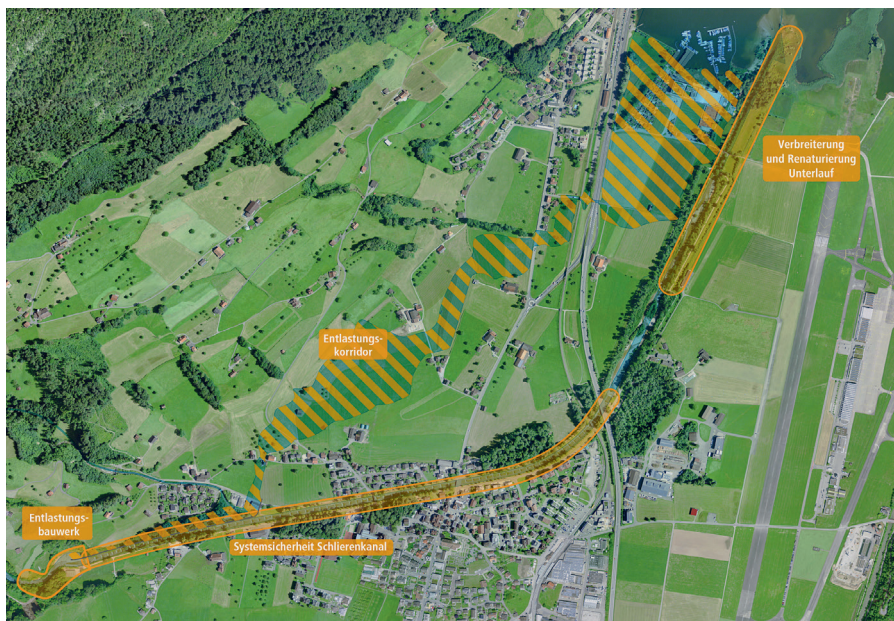
Luftbild mit vier Bestandteilen des Projekts: Entlastungsbauwerk, Systemsicherheit Schlierenkanal, Verbreiterung und Renaturierung Unterlauf, Entlastungskorridor
